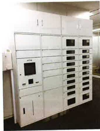
写真1) 宅配ボックスの設置が容易に建物用途や設置場所によらず、宅配ボックス設置部分は一定の範囲内で容積率不算入となる。写真はオフィスに設置した宅配ボックス (写真: 国土交通省)
